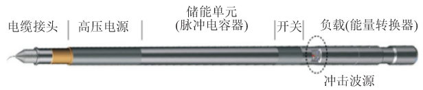
图 1 重复脉冲强冲击波产生装置结构
